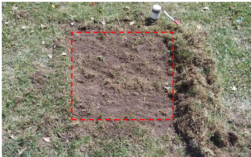
Figure 8.1 : illustration de la technique de prélèvements de sols superficiels
